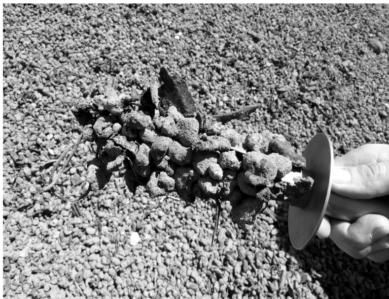
Abb. 1: Verzunderte, mit Mineralien ummantelte, feinkörnige Qualitäten von Fe-Schrott, gehalten durch einen Stabmagneten
